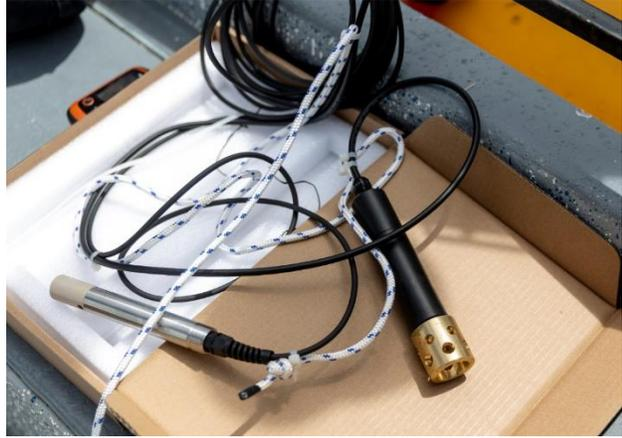
Figura 2 Sensores de medida de temperatura, conductividad y oxígeno disuelto. Fuente: equipo Más-Azul.
